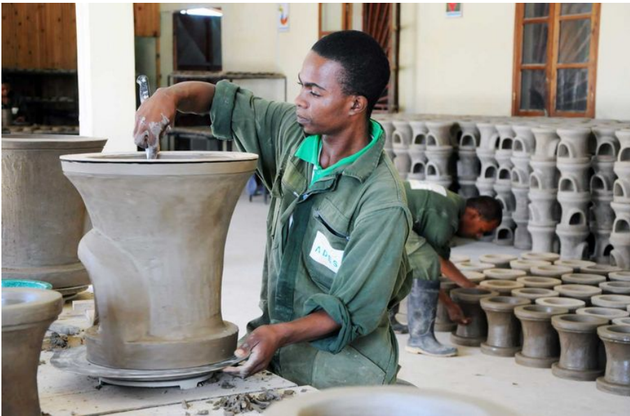
Benjamin Rakotovaomanana am Fertigstellen einer Ton-Brennkammer eines Energiesparkochers für Schulen. Foto: Angela Zimmermann
