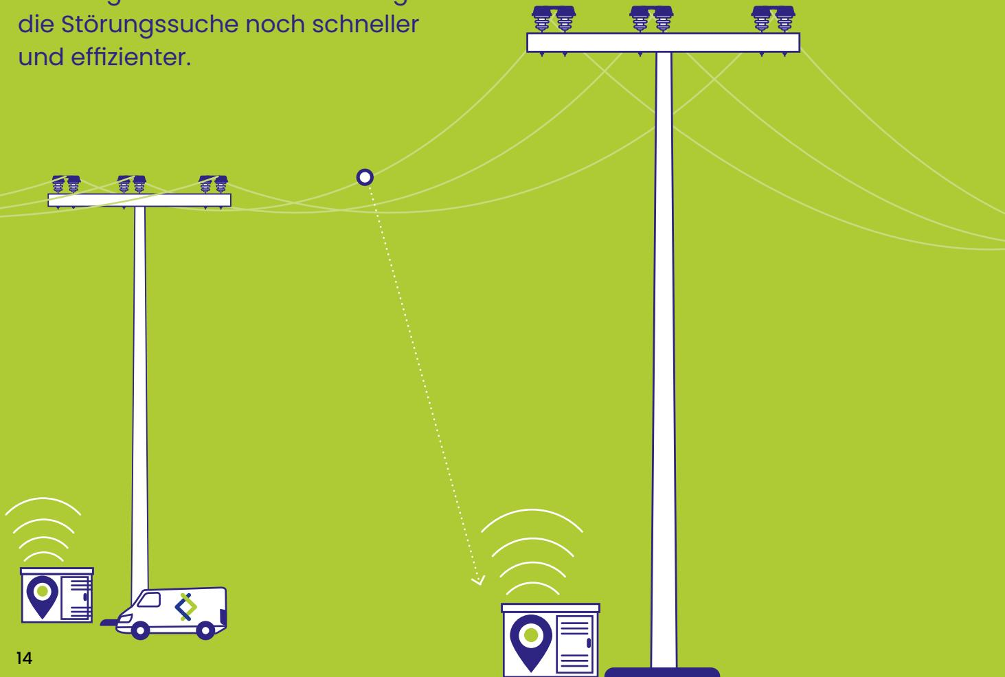
Aktuell sind in den Stationen Kurzschlussanzeiger installiert. Sie blitzen, sobald ein Fehler im Netzabschnitt auftritt. Für die Monteure bedeutete das: Station für Station abzufahren, die Kurzschlussanzeiger abzulesen und damit den Fehler auf einen Leitungsabschnitt zwischen zwei Stationen zu lokalisieren. Das funktionierte zuverlässig, kostete aber Zeit.
